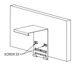
INSTALL THE SUPPORT ON THE JOIST AT THE NEEDED HEIGHT DEPENDING OF THE GYPSUM THICKNESS.
