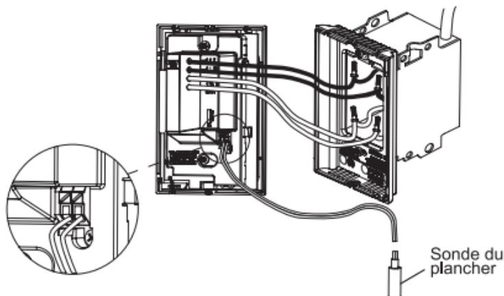
6. Remplacez la partie avant du thermostat sur la base et resserrez la vis au bas de l'appareil.
