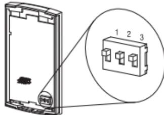
1. El encendido anticipado funciona en Modo Automático solamente. Cuando la función está activada, el termostato calcula la hora óptima para encender la calefacción a fin de obtener la temperatura de Confort al comienzo de los períodos 1 y 3. Cuando esta función está desactivada (**Off**) la calefacción se enciende solamente al comienzo de los períodos 1 y 3, por lo que hay una demora antes de que se alcance la temperatura de Confort.
