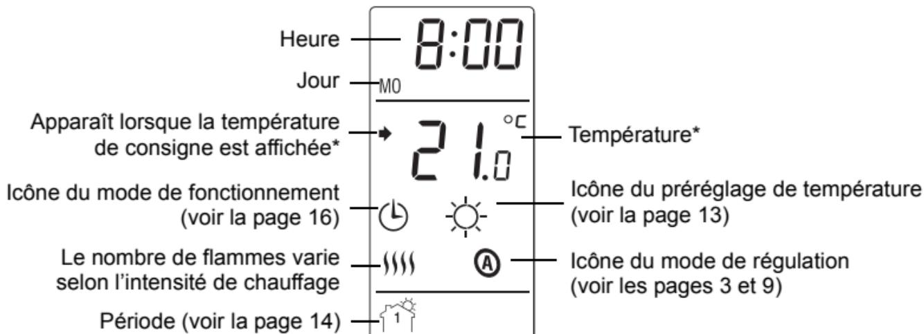
\* Le thermostat affiche normalement la température réelle (mesurée). Pour voir la température de consigne, appuyer brièvement sur l'un des boutons ▲▼. La consigne sera affichée pendant 5 secondes. Pour changer la température de consigne, appuyer sur l'un des boutons ▲▼ jusqu'à ce que la température désirée soit affichée. Pour faire défiler la température de consigne plus rapidement, maintenir le bouton enfoncé.
