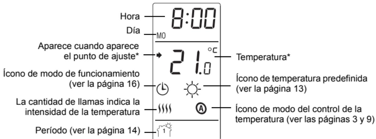
\* El termostato indica normalmente la temperatura real (medida). Para ver la temperatura del punto de ajuste, presionar brevemente uno de los botones ▲▼. El punto de ajuste aparecerá durante 5 segundos. Para cambiar la temperatura del punto de ajuste, presionar uno de los botones ▲▼ hasta que se visualice la temperatura deseada. Para hacer desfilar más rápido la temperatura del punto de ajuste, mantener el botón presionado.
