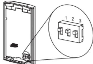
1. La fonction de Démarrage anticipé n'est utilisée qu'en mode Automatique. Lorsque la fonction est activée, le thermostat détermine l'heure d'activation du chauffage afin que la température Confort soit atteinte au début des périodes 1 et 3. Lorsque la fonction est désactivée, le chauffage ne démarre qu'au début des périodes 1 & 3; donc il y a un délai avant que la température Confort soit atteinte.
